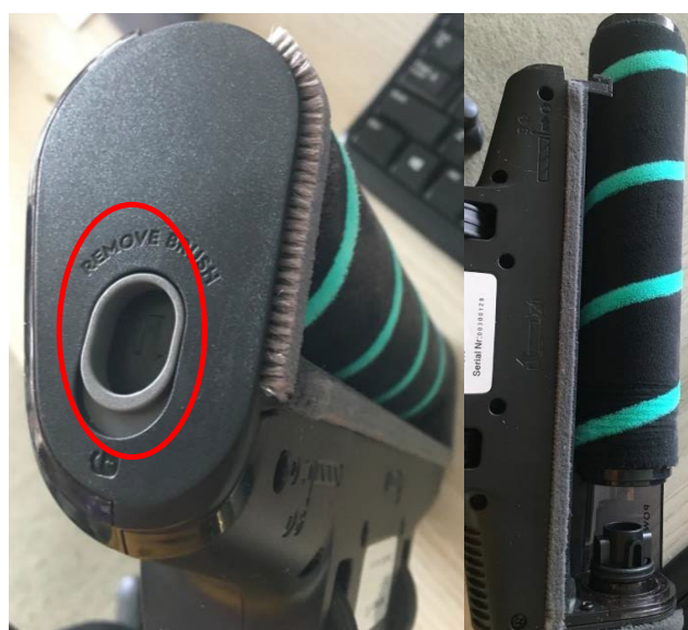
24. Retirez le couvercle droit, démontez la barre à brosse, dévissez les deux vis du couvercle gauche, puis démontez le couvercle gauche.
